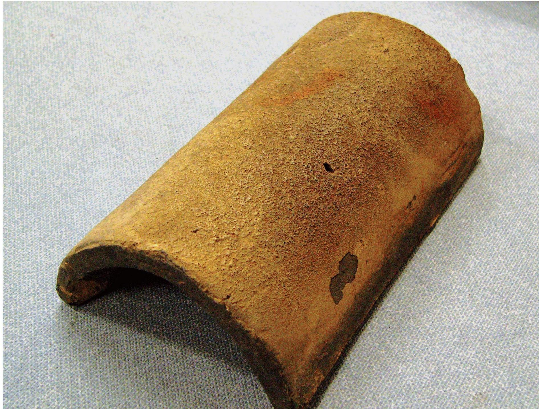
Como resultado por receber diretamente os raios de calor provenientes da explosão atômica, a telha foi aquecida ao ponto de deixar bolhas (provenientes de borbulhamento) em sua superfície. Resultados de experimentos mostram que padrões de bolhas similares ocorrem quando as telhas são expostas a um calor de 1.800 graus celsius por 4 segundos.
